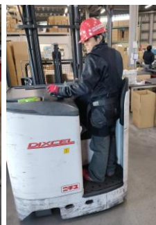
アシストギアを装着 したままフォーク リフトの運転が可能
