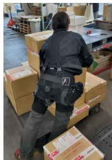
パレットへの積込 作業時の腰への負担 を軽減
